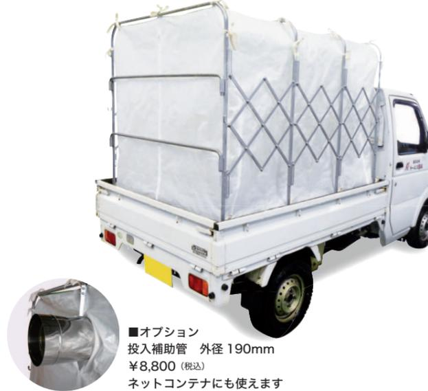
上面をメッシュ、側面をシートにし、ゴミの飛散を最小限に！弊社独自の構造により、スライド部の強度がバツグン！
